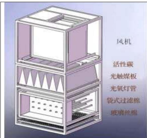
喷漆房废气处理装置组成
