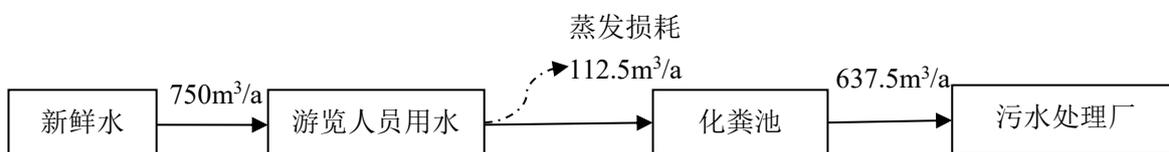
图1-1项目水平衡图
